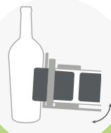
Précision de l'habillage sur bouteilles coniques par inclinaison des postes d'étiquetage
